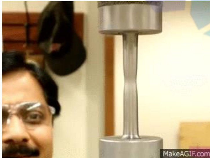
تست استحکام کششی میله آلومینیومی
